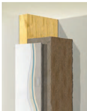
Kiszellőztetett favázás szerkezet
