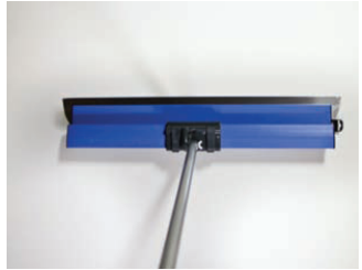
Mennyezeten is széles simítóval elhúzott 2-3 mm vastag glettelés, vékonyvakolat.
